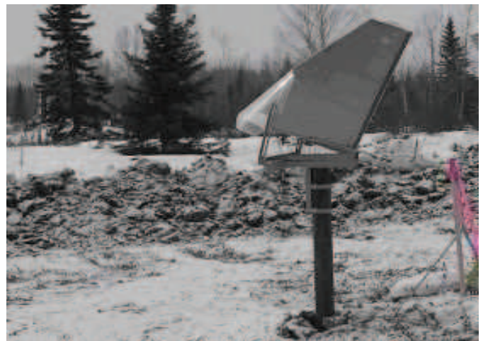
Fig. 6 : Réflecteur d'aluminium installé dans la zone d'intérêt pour garantir un point de mesure
